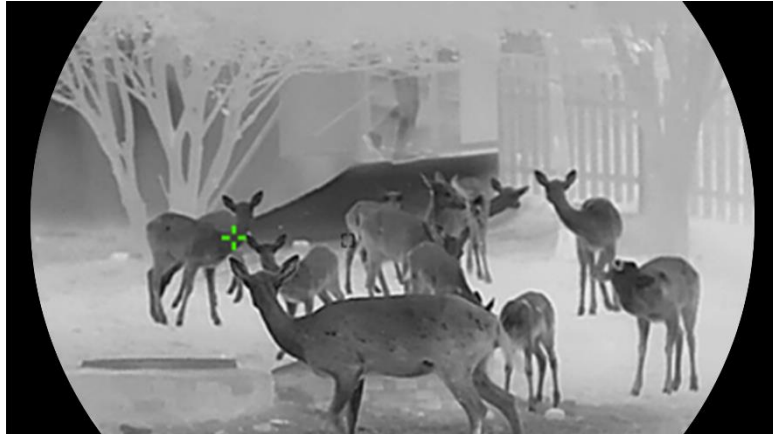
Abbildung 5-1 Stelle mit höchster Temperatur verfolgen
